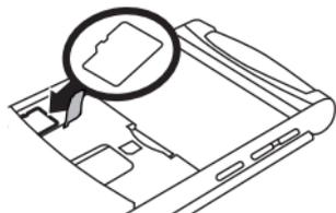
Para retirar la tarjeta de memoria, levante la goma de protección y deslice la tarjeta de memoria fuera del sujetador.
